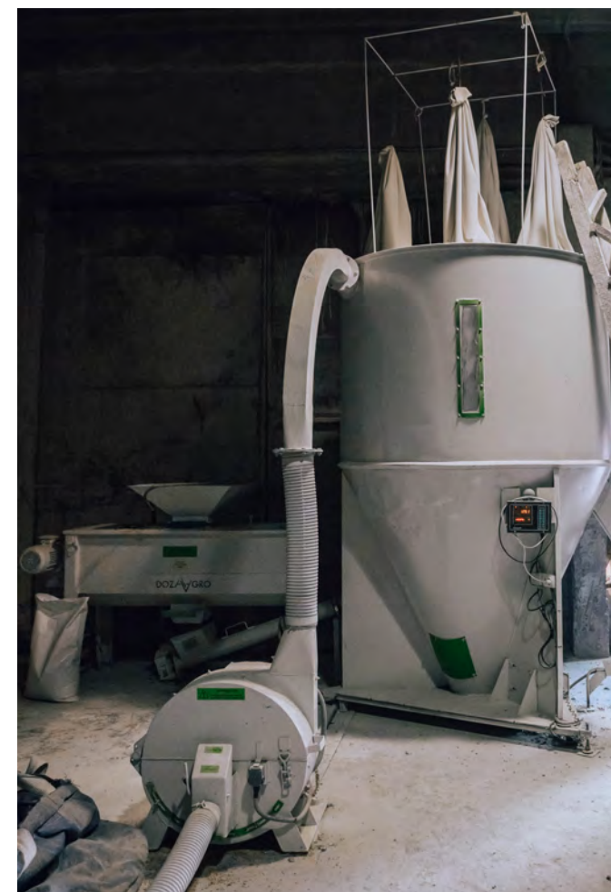
Линия по производству рассыпных комбикормов КПК, Липецкая область
